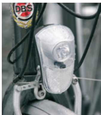
AUTOMATISK. DBS-sykkelen hadde lykter som automatisk slår seg på når det er behov for lys.
